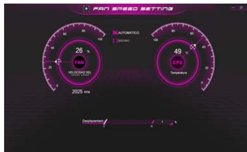
Figura 8 - Control de velocidad de FAN
