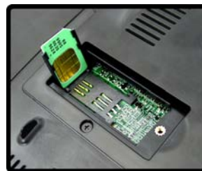
Abb. 13 - Einsetzen der USIM-Karte und Schließen des SIMLOCK-Riegels
