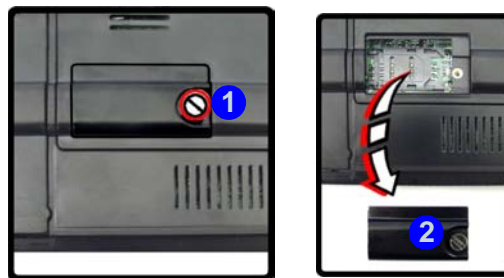
Figure 12 - Retirer le couvercle de la carte SIM
