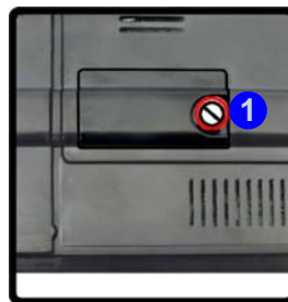
Abb. 12 - Abnehmen der SIM-Kartenfachabdeckung
