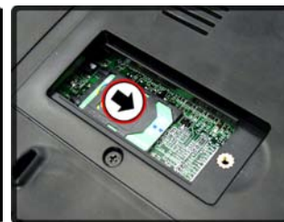
Abb. 13 - Einsetzen der USIM-Karte und Schließen des SIMLOCK-Riegels
