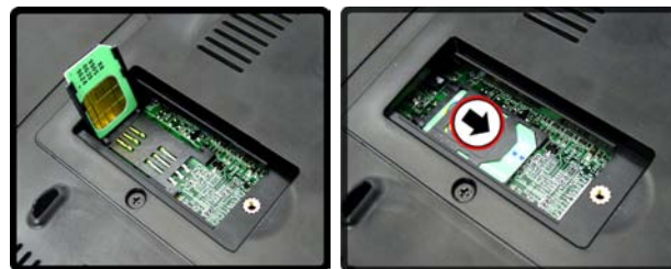
Figure 13 - Insérez la carte USIM & verrouillez le SIMLOCK
