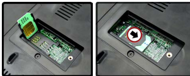
Figura 13 - Insertar la tarjeta USIM & bloquear SIMLOCK
