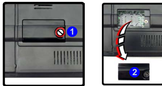
Figura 12 - Rimozione del coperchio della carta SIM
